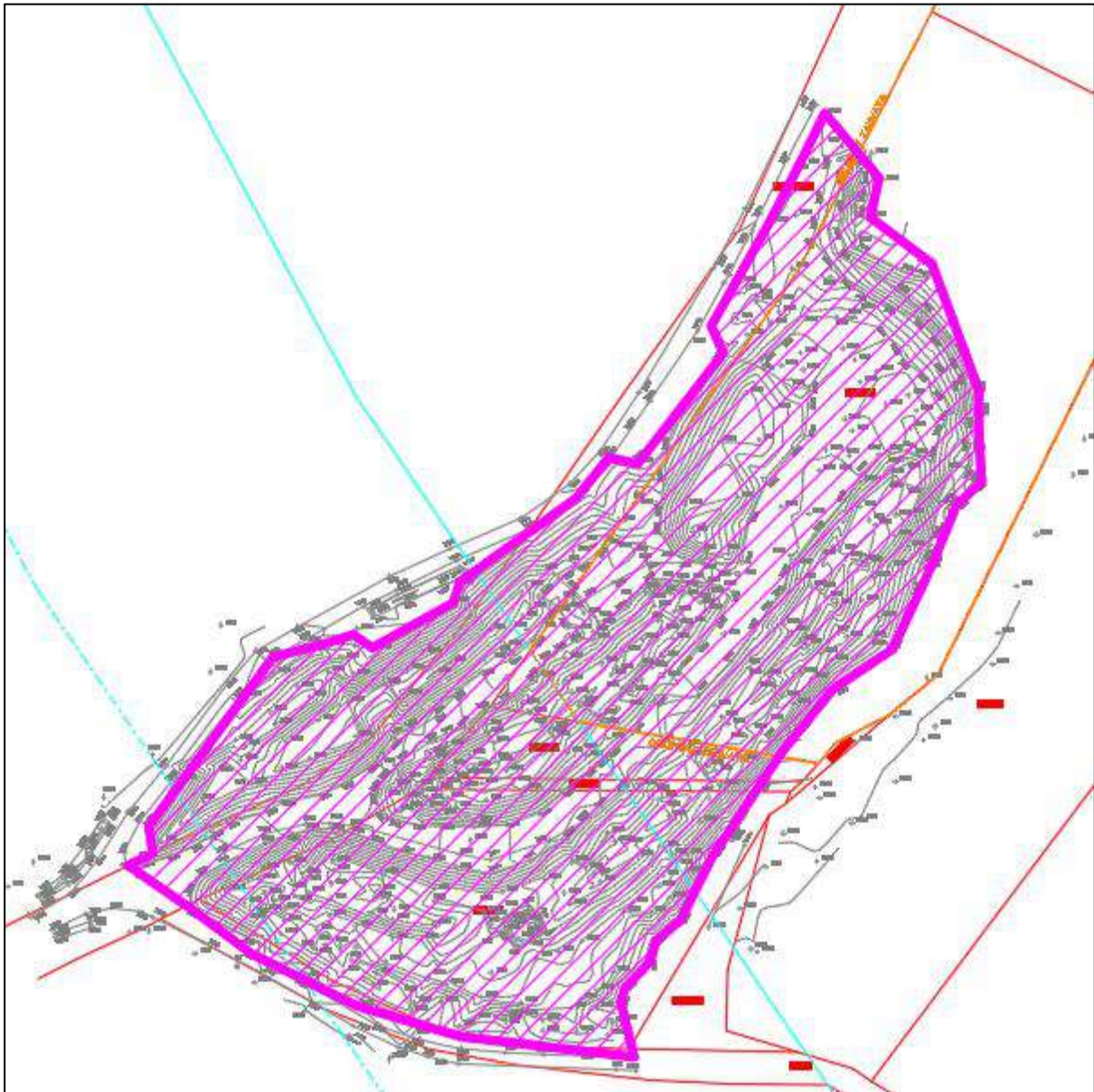
Slika 2.2.-1. Granice rasprostiranja otpada prema geodetskoj snimci i provedenim istražnim radovima
